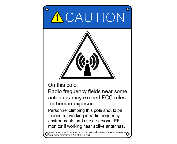
6 RF WARNING SIGNAGE SCALE: N.T.S.
